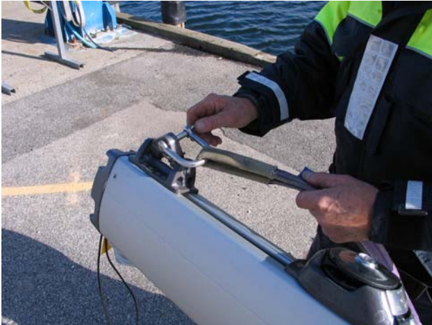
Fig. 3. FASTGØRELSE AF LØFTESTROP I BUNDEN AF MASTEN.
